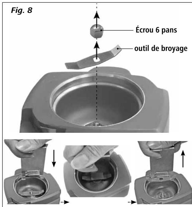
**Remarque:** pour sortir la lame en étoile **A10.2**, utilisez les crochets du support pour tenir la lame. La lame peut être sortie de la chambre (voir **Fig. 9**, **Fig. 10**).
