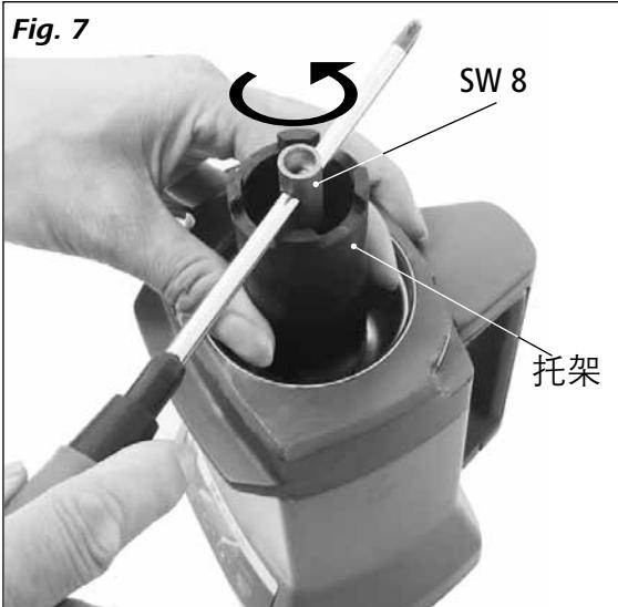
**注意:** 当要取出A10.2剪切研磨刀具时, 可利用托架上的钩来保住研磨刀具。之后, 则可将研磨刀具从研磨室取出(见 Fig. 9, Fig. 10)。
