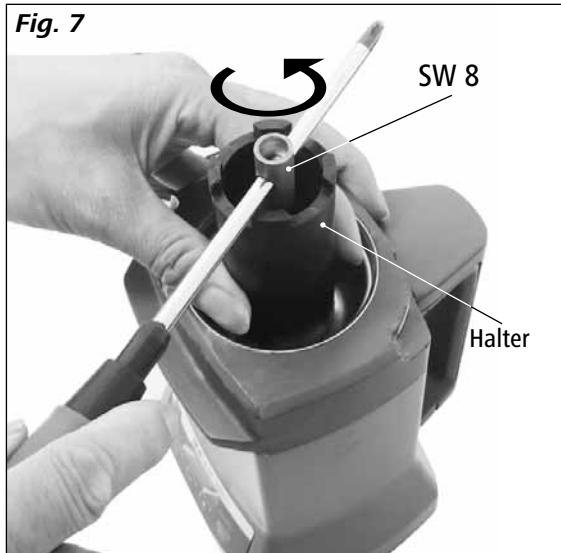
Daraufhin können die Sechskantmutter und das Mahlwerkzeug aus der Mahlkammer entnommen werden.
