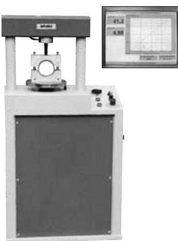
**20-1672****Marshall-Druckprüfmaschine 30 KN**
